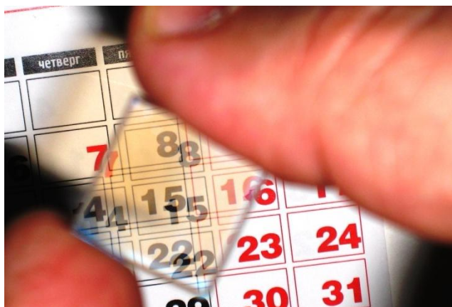
Рис. 2. Двулучепреломление в кристалле исландского шпата.
