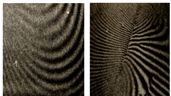
Рис. 2а. Исходная муаровая топограмма (до внесения дислокаций). (x6)
